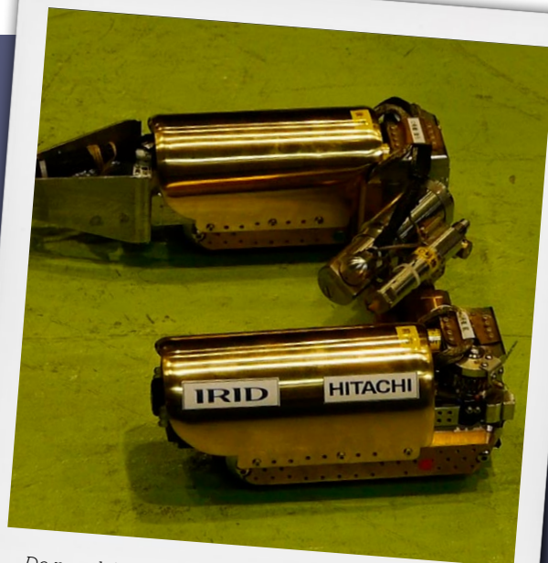
De ny-udviklede robotter kan ændre form og styres via en fjernbetjening, som de er koblet til via et 40 meter langt kabel.
