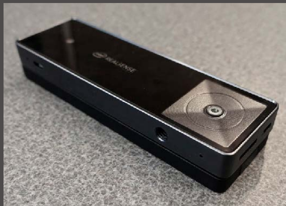
Euclid er udstyret med accelerometer og gyroskopiske bevægelsessensorer. Data overføres via usb 3.0 og micro-HDMI-porte
